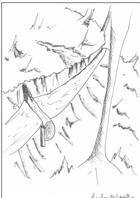
FIGURA 54 – Barreira de escoamento em madeira.
